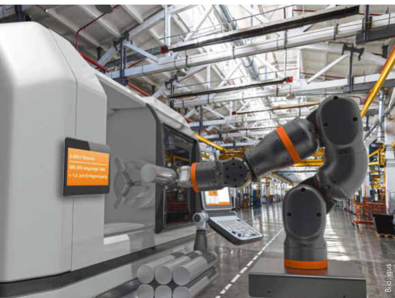
Low-Cost-Automatisierung spart Geld: Bei einem Roboter-Preis von rund 5.000 Euro und 500.000 Picks liegen die Kosten pro Pick bei nur 1 Cent. Wenn die Lebensdauer des Roboters wie beim igus ReBeL bei mindestens 2 Millionen garantierten Zyklen liegt, sinken die Kosten noch deutlich weiter.
